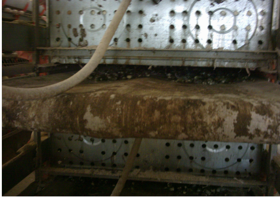
Şekil 2. 8 Tavuk gübrelerinin atık bandıyla ortamdan uzaklaştırılması
