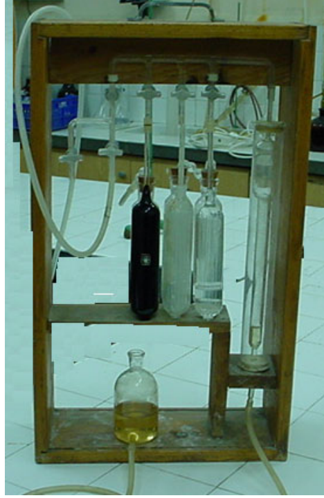
Şekil 3. 2 Orsat-tipi gaz analiz cihazı
